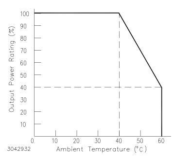
FIGURE 5. % OUTPUT POWER RATING VS. AMBIENT TEMPERATURE
